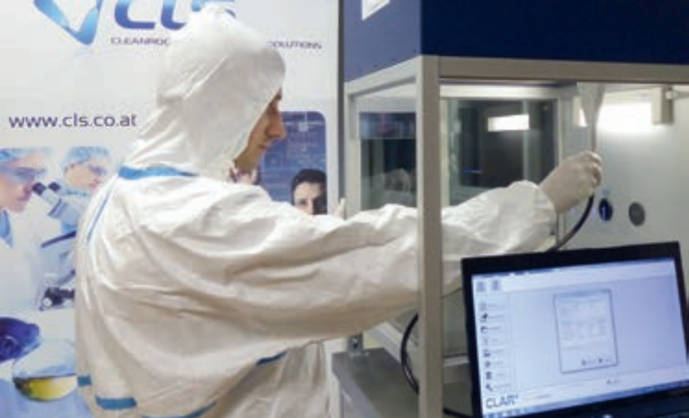
© CLS Mit dem Softwarepaket CLAR können automatisiert normgerecht Testprotokolle erstellt werden.
